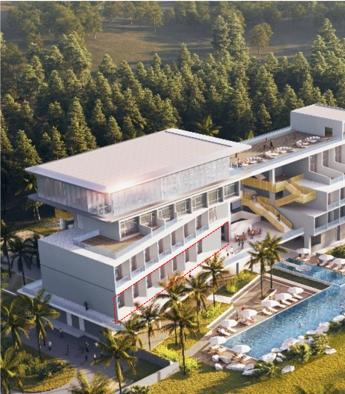
原二层大堂区调整为客房区及健身房，取消原通透玻璃加木格栅门扇，立面调整为客房门窗玻璃及露台矮墙。
